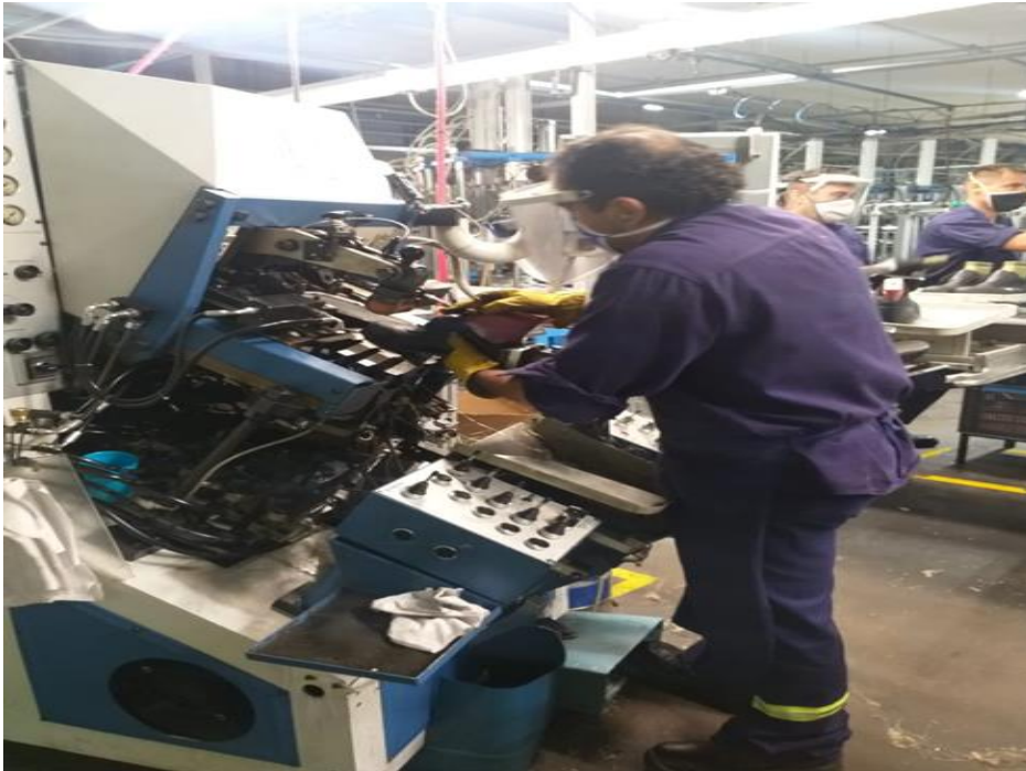
Máquina de tirado de puntera
