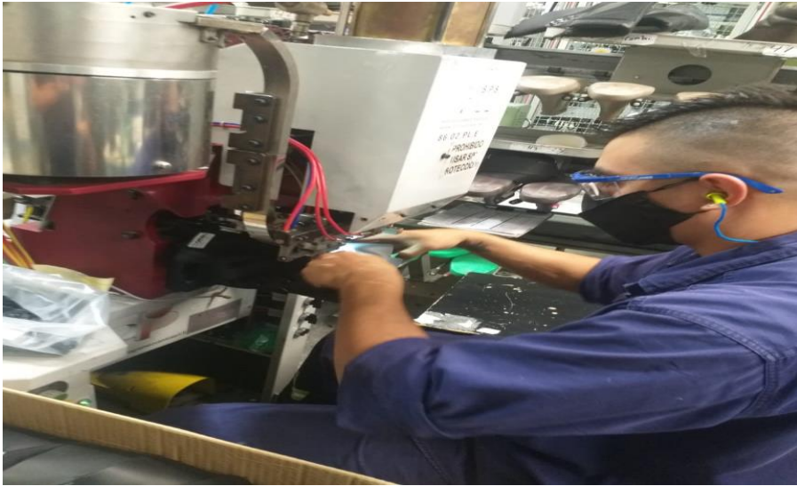
Maquina colocadora de ganchos para cordones
